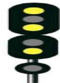
Ответ. На отдельных станциях, на входных и маршрутных светофорах может применяться сигнал: три желтых огня – разрешается локомотиву, мотор-вагонному поезду, мотовозу, дрезине следовать на свободный участок пути с особой осторожностью и со скоростью – не более 20 км/ч до маршрутного светофора с красным огнем!
