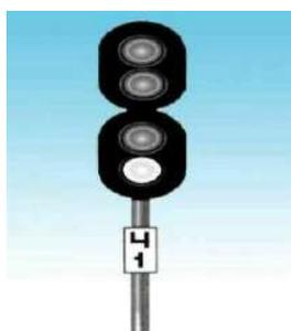
Ответ: Лунно-белый огонь на выходном светофоре при отправлении поезда на ответвлении указывает на готовность маршрута, а разрешением на отправление служит ключ-жезл или путевая записка!
