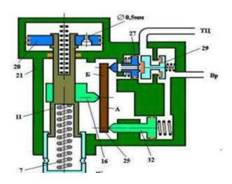
Авторежим кронштейном крепиться к хребтовой балке вагона. При загрузке вагона вследствие прогиба рессор упор авторежима упирается в опорную плиту, закрепленную на поперечной балке, соединенной с боковинами тележки вагона. Вследствие этого вилка 9 утапливается в корпусе демпферной части, а демпферный поршень вместе с ползуном и сухарем перемещается вверх и соотношение плеч «А» и «Б» рычага 25 (Рис.)
